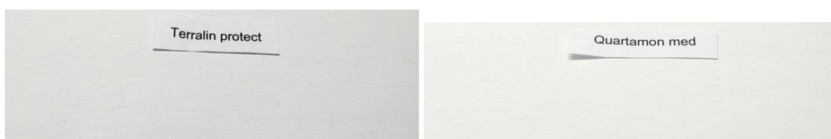
Abbildung 3: Probe nach 1h Belastungsdauer – Terralin protect + Quartamon med
